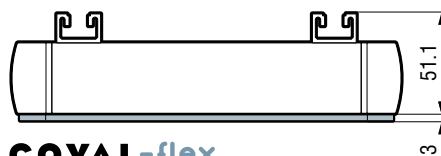
Pletina "COVAL-flex" espesor 3 mm
